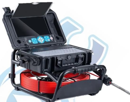
Caméra d'inspection idéale pour les piscinistes, la petite tête de caméra de diamètre 14 mm est montée directement sur un jonc assez souple pour réaliser des inspections avec des coudes en PVC de diamètre 50mm extérieur et allant jusqu'à 30 m. Elle est équipée, comme les autres caméras d'inspection de la gamme, d'une régie avec enregistrement numérique sur carte SD. Sa longue autonomie de 5h vous permet de travailler sans fil toute la journée.
